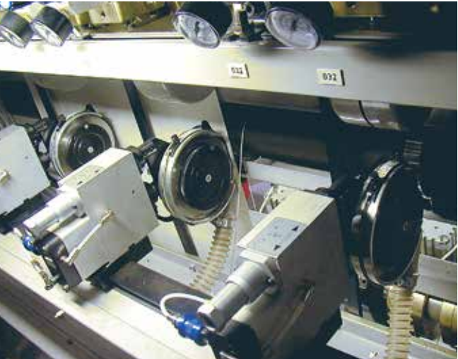
Sugkåpa monterad på skärkniv i tryckpressen
