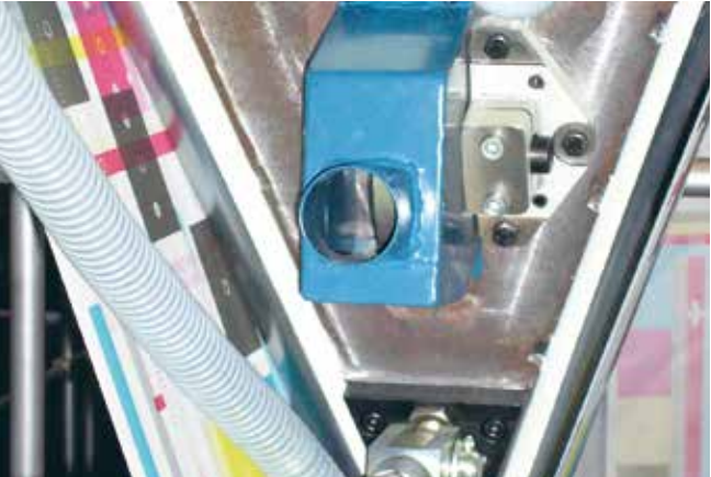
Sugkåpa monterad på skärkniv i tryckpressen
