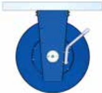
Slangstyrningen monteras uppåt.
