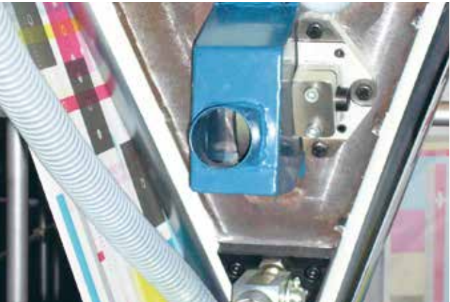
Sugkåpa monterad på skärkniv i tryckpressen
