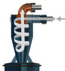
Der DC F 60 Vorabscheider eignet sich für das Absaugen von großen Staubmengen und insbesondere auch für das Abscheiden von Grobschmutz. Bis zu 90 % des Staubes werden im vorgesetzten
