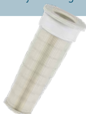
Finfilter polyester - högkvalitativt filter som tål de flesta ämnen. Mycket lämpad för våta miljöer, t ex i mekanisk industri i samband med skärvätskor etc. Ytan är något glattare än hos cellulosafiltret, vilket gör filterrensningen effektivare och livslängden ökar.
