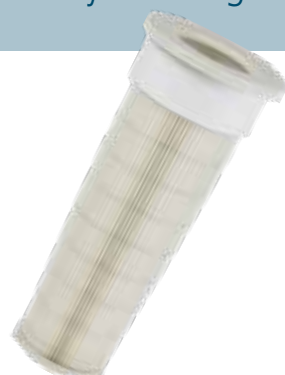
Finfilter polyester- högkvalitativt filter som tål de flesta ämnen. Mycket lämpad för våta miljöer, t ex i mekanisk industri i samband med skärvätskor etc. Ytan är något glattare än hos cellulosafiltret, vilket gör filterrensningen effektivare och livslängden ökar.
