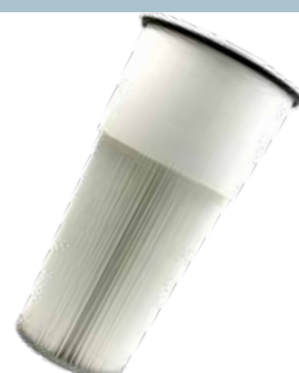
Finfilter, PTFE - polyesterfilter behandlat med PTFE, vilket gör att filterbeläggningen mycket lätt lossnar från filterytan. Filtret används med fördel vid t ex golvslipning.
