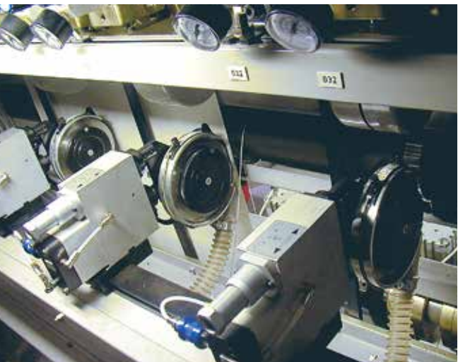
Sugkåpa monterad på skärkniv i tryckpressen
