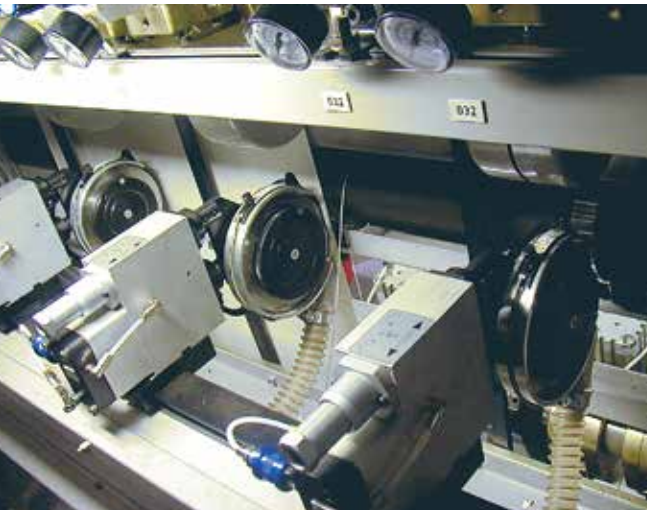
Sugkåpa monterad på skärkniv i tryckpressen
