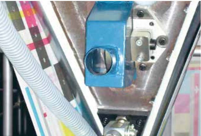
Sugkåpa monterad på skärkniv i tryckpressen
