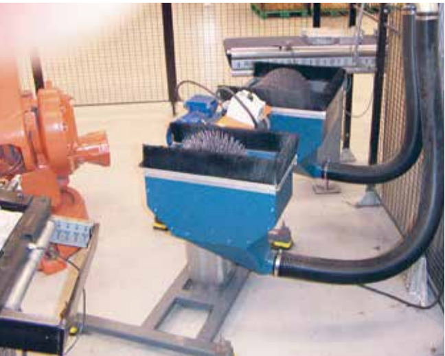
Robotavgradning för telekomdelar
